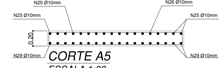
LAJE CXPV01 ARMAÇÃO SUPERIOR ESCALA 1:30
